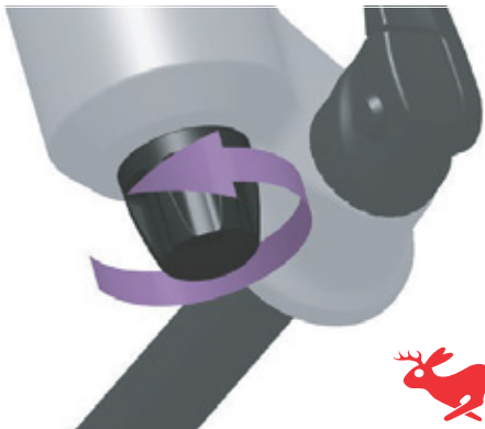
Afbeelding 137: Draai de trekdemperafsteller in de richting van de haas
