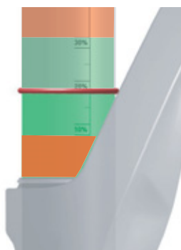
Afbeelding 85: Voorgeschreven sagbereik (groen) en verboden sagbereik
