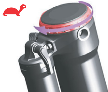
Afbeelding 143: Draai de trekdemperafsteller in de richting van de schildpad
