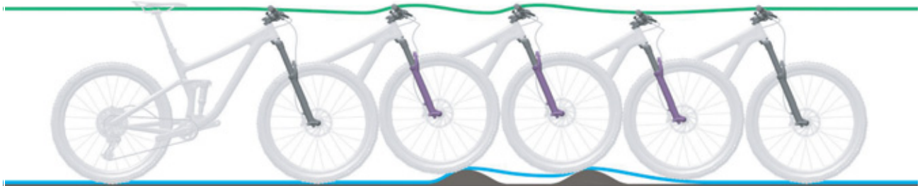
Afbeelding 136: Te langzaam uitveren van de verende voorvork
