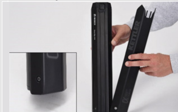
Afbeelding 43: Accuafdekking op de accu schuiven
