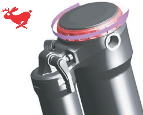
Afbeelding 145: Draai de trekdemperafsteller in de richting van de haas
