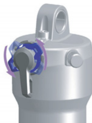
Afbeelding 101: Drukdemperafsteller zachter afstellen
