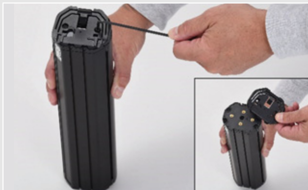
Afbeelding 44: Demontage bovenste interface
