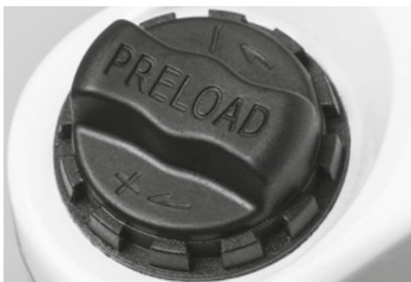
Afbeelding 79: Afstelwiel voor de sag op de kroon van de verende voorvork
