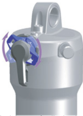
Afbeelding 147: Drukdemperafsteller harder afstellen
