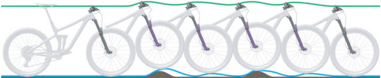
Afbeelding 134: Te snel uitveren van de verende voorvork
