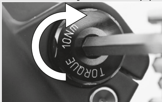
Afbeelding 52: Aangebrachte as vastdraaien
