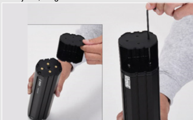
Afbeelding 45: PowerTube verlengstuk monteren
