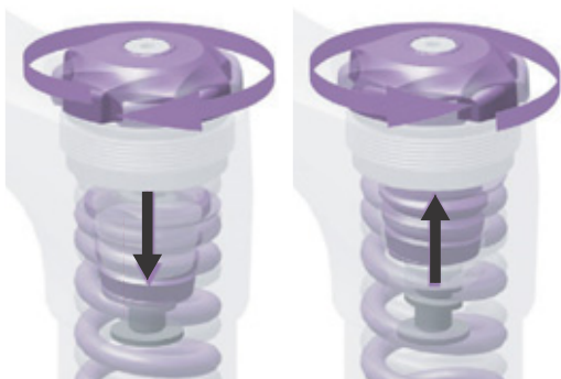
Afbeelding 82: Voorspanningsafstelling in- en uitdraaien.
