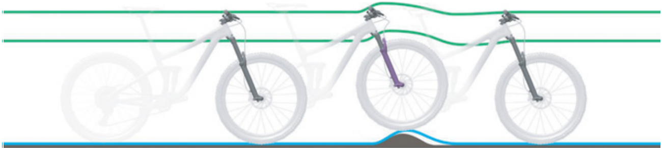
Afbeelding 140: Te harde demping de verende voorvork bij oneffenheden
