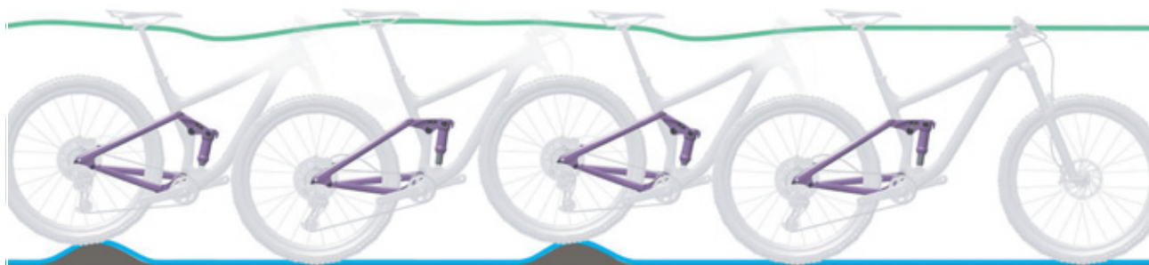
Afbeelding 10: Optimaal rijgedrag van de achterbouwdeemper
