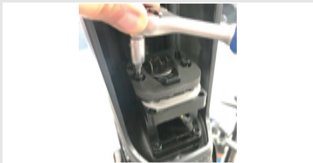
Afbeelding 35: Schroeven accuhouder losdraaien
