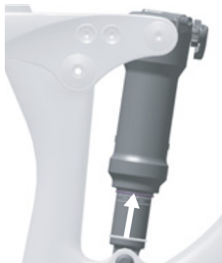
Afbeelding 87: O-ring op de achterbouwdemper verschuiven
