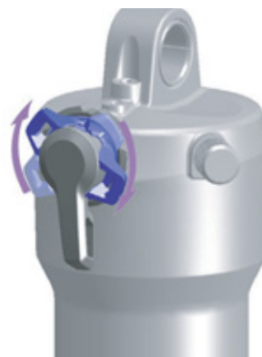
Afbeelding 100: Drukdemperafsteller harder afstellen
