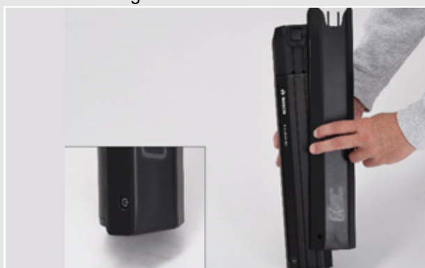
Afbeelding 47: Accuafdekking op de accu schuiven
