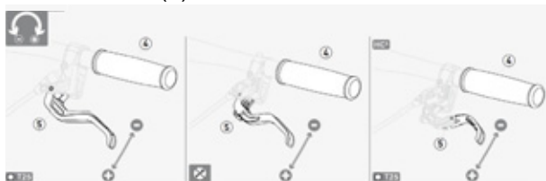
Afbeelding 77: Grijpafstand Magura schijfremhendel afstellen
